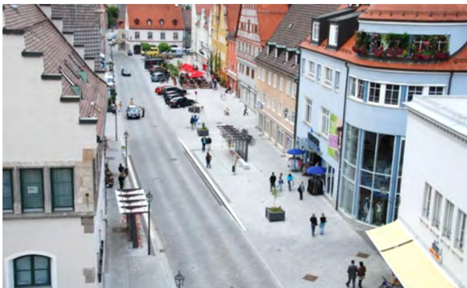
Obr. 11 – Příklad vhodného řešení zastávky veřejné dopravy ve sdílené zóně. Zřízení zvýšené nástupní hrany je výjimkou z pravidla jedné výškové úrovně. Obsluha veřejnou dopravou je klíčová z pohledu trvale udržitelné mobility (zdroj: TU Graz)
