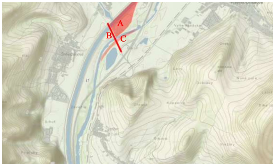
obr. 22 – Posunutie hrádze rešpektujúce krajinný priestor. A-hrádza, B-prechod cez Váh, C – posun starého koryta. Zdroj podkladu: LLS UGKK SR, schéma autor
