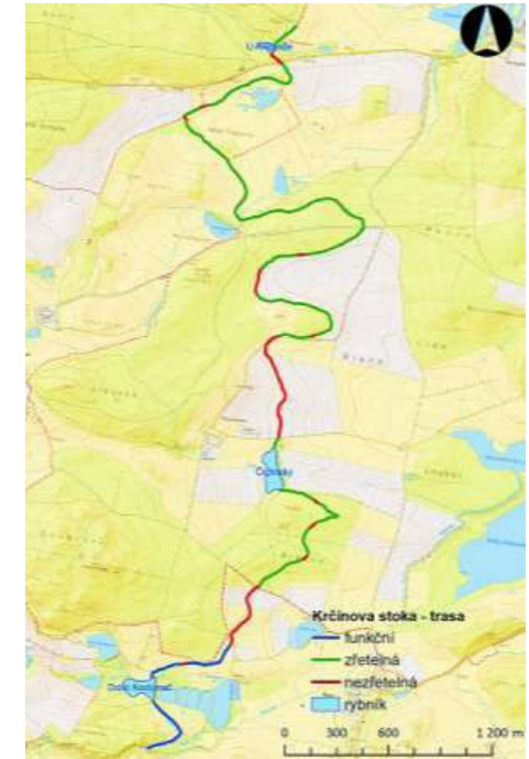
obr. 11 – Vlevo schéma vedení stoky Krčínka krajinou od lesní rokle pod Hrádečkem (dole) k bývalé lesovně U Ambrože (nahore), s vyznačením původní hranice obory, podle map stabilního katastru a leteckého měřického snímkování. Vpravo schéma s vyznačením současného stavu stoky podle průzkumů in situ, doplněného o výsledky lidarového snímkování. (Mapový podklad ČÚZK).
