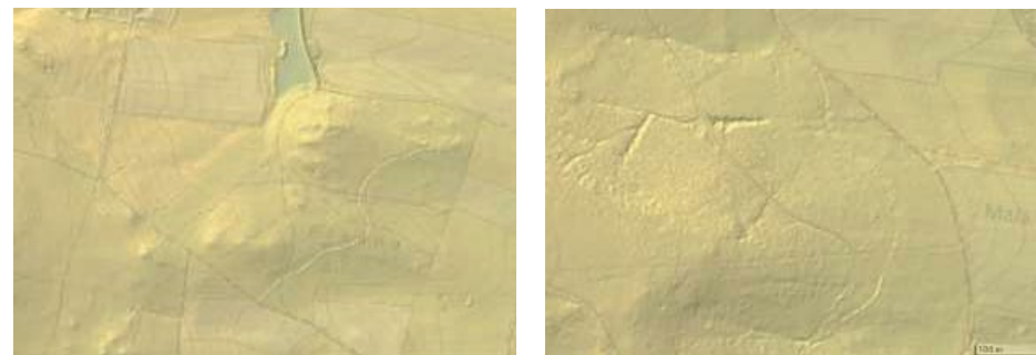
obr. 8 – Vlevo na výřezu z lidarové mapy reliéfu terénu je zřetelně indikován úsek přerušené a nefunkční části stoky Krčínka v prostoru lesa Brašna nad Čichtickým rybníkem. (Mapový podklad ČUZK). Vpravo na výřezu lidarové mapy terénu je indikováno patrně původní Krčínovo pokračování stoky Krčínka od lesovny U Ambrože, lesem Třebánka k Malému Tringlovskému rybníku. (Mapový podklad ČUZK).
