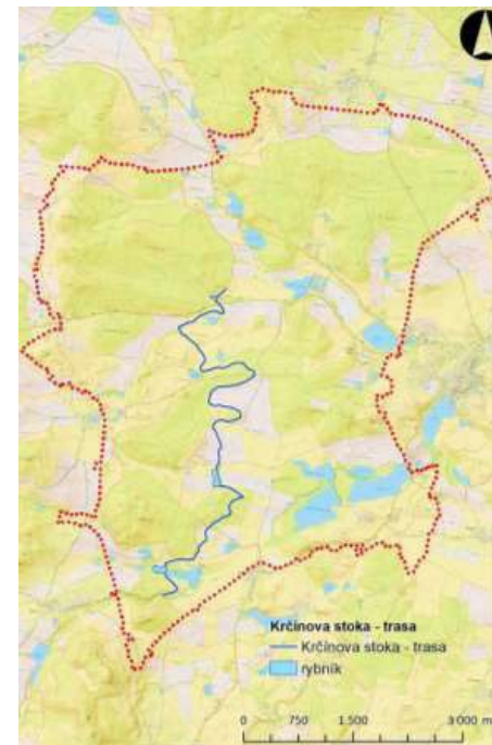
obr. 11 – Vlevo schéma vedení stoky Krčínka krajinou od lesní rokle pod Hrádečkem (dole) k bývalé lesovně U Ambrože (nahore), s vyznačením původní hranice obory, podle map stabilního katastru a leteckého měřického snímkování. Vpravo schéma s vyznačením současného stavu stoky podle průzkumů in situ, doplněného o výsledky lidarového snímkování. (Mapový podklad ČÚZK).
