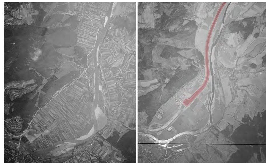
obr. 3 a 4 – Krajina bez kanála v roku 1949 a klyn 7 metrov vysokého násypu v urbanizme mesta medzi Považským Podhradím a Považskou Teplou v roku 1965. Zdroj: Topografický ústav Banská Bystrica
