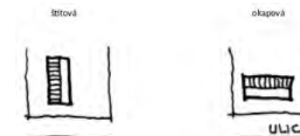
obr. 18 – Venkovská zástavba – orientace střechy – štítová, okapová, (Koubková, Stojan)
