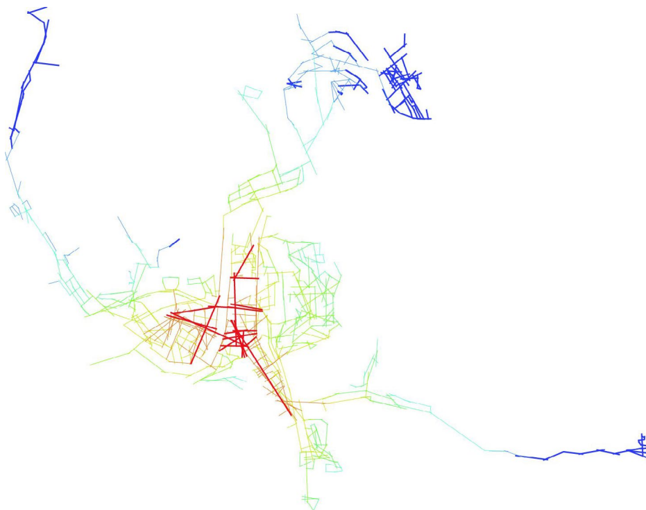
obr. 7 - Integration 'n' - miera integrácie axiálneho grafu - identifikácia mestského centra so započítaním všetkých bodov vzhľadom na všetky ostatné body v grafe (heat map - červená znázorňuje ktoré časti sú najviac integrované, modrá naopak odhaľuje tzv. koncové štruktúry reprezentácie sieťovej štruktúry) Červeným je vyznačené existujúce centrum mesta D. Kubín. Analýza priestorov reprezentovaných sieťou potvrdzuje význam centrálného mestského ťažiska v 'globálnej' - celkovej mierke.
