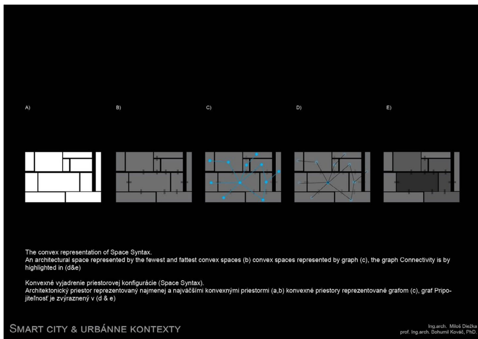
obr. 6 - Konvexné vyjadrenie priestorovej konfigurácie (Space Syntax). Architektonický priestor reprezentovaný najmenej a najväčšími konvexnými priestormi (a,b) konvexné priestory reprezentované grafom (C), graf Pripojiteľnosť je zvýraznený v (d & e)
