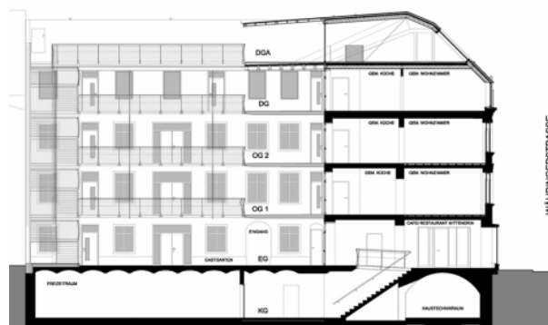
obr. 4 - Řezopohled objektem VinziRast Mittendrin. Suterén byl proměněn ve společenský sál, v přízemí se nachází restaurace a dílny, ve třech podlažích byty a podkrovní uzavírá sál s velkorysým výhledem a terasa pro setkávání a společné trávení volného času obyvatel (Zdroj: Gaupenraub+/-)
