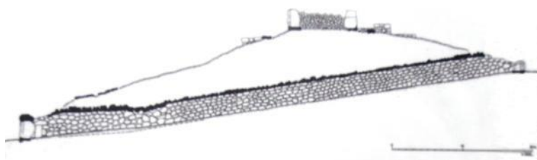
obr. 18 - Řez výpádovou chodbou pod branou Yerkapi (Brána sfing) (Zdroj: Bogazkale Open Air Museum)
