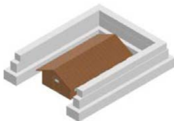
Obr. 11 Jednotlivý modul: ubytovací B-Hut s defense wally (Zdroj: Markéta Lavická)
